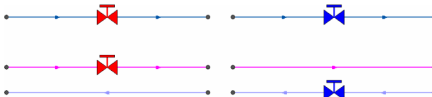
Рисунок 2.33. Сверху: однолинейное изображение сети, снизу – внутренне представление
