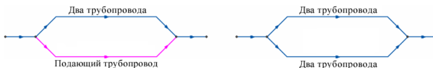
Рисунок 2.6. Изображение трехтрубной и четырехтрубной сети
